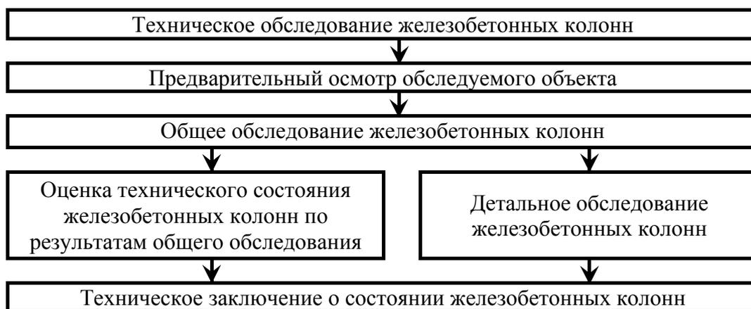
Рисунок 2.1 – Схема последовательности выполнения технического обследования железобетонных колонн
