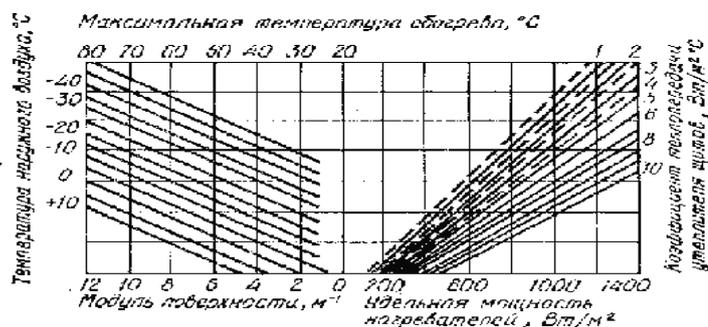
Рисунок 2 – Номограмма для определения предельно допустимых удельных мощностей ( $P_{\text{уд}}$ ,  $\text{Вт/м}^2$ ) нагревателей греющей опалубки по модулю поверхности ( $M_{\text{п}}$ ,  $\text{м}^2$ ), температуре наружного воздуха ( $t_{\text{н.в}}$ ,  $^\circ\text{C}$ ), максимальной температуре обогрева ( $t_{\text{мак}}$ ,  $^\circ\text{C}$ ) и коэффициенту теплопередачи утеплителя щитов ( $K$ ,  $\text{Вт/м}^2 \cdot ^\circ\text{C}$ )
