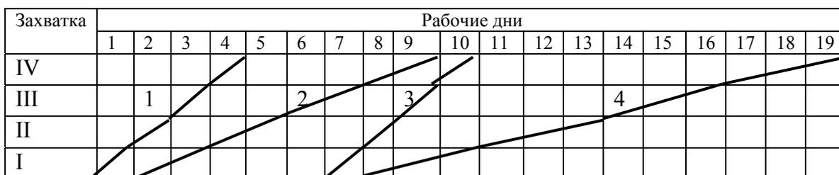
Рисунок 10 - Циклограмма неритмичного потока с однородным изменением ритма, рассчитанного с использованием матрицы
