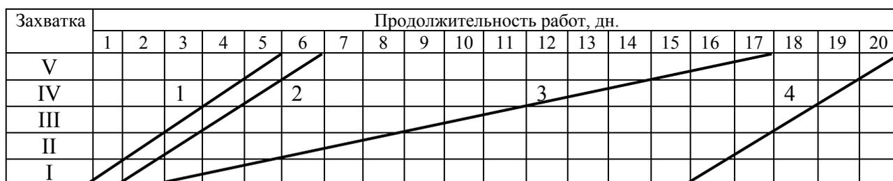
Рисунок 6 – Циклограмма специализированного кратноритмичного потока до уравнивания
