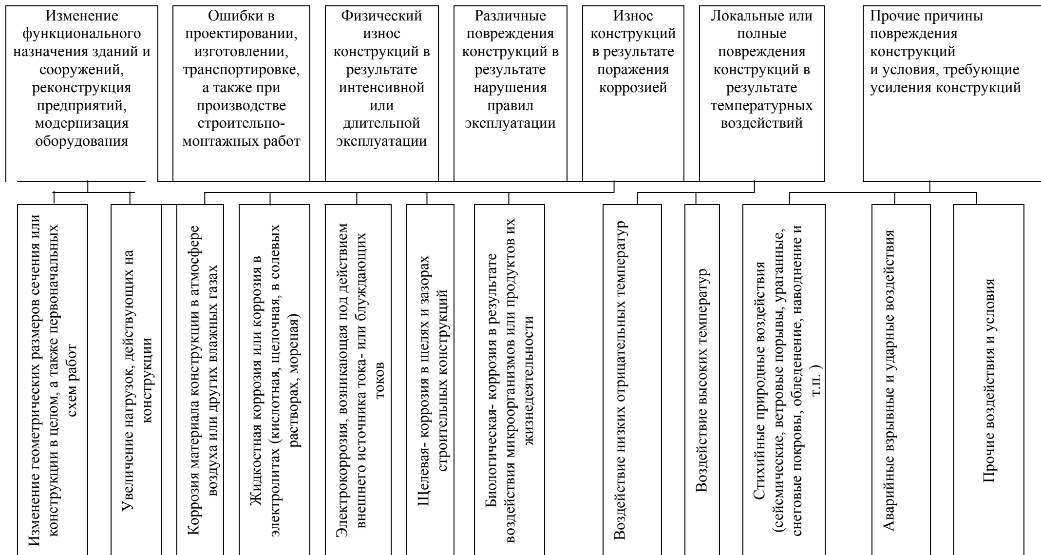
Рисунок 3.1 – Классификация причин, вызывающих необходимость обследования фундаментов
