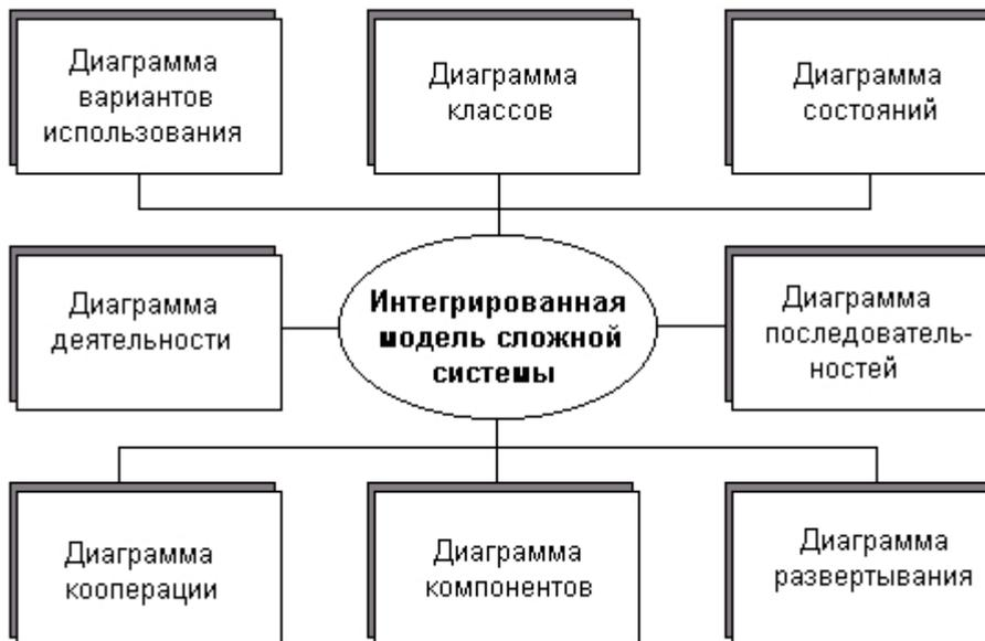
Рис. 5 Интегрированная модель сложной системы в нотации UML
