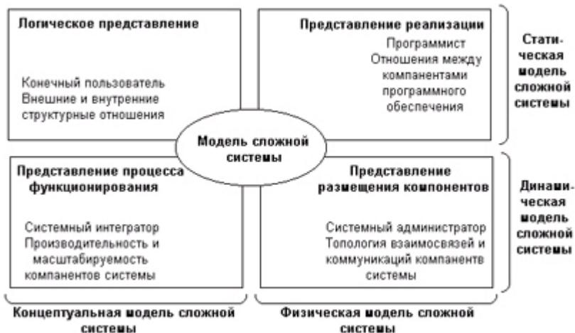
Рис. 3. Общая схема взаимосвязей моделей и представлений сложной системы в процессе объектно-ориентированного анализа и проектирования
