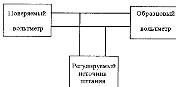
Рисунок 2.6 – Схема включения приборов для поверки вольтметра
